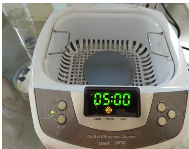
2.1.1 Сурет - Пластинаның ультрадыбысты ваннада тазалануы
